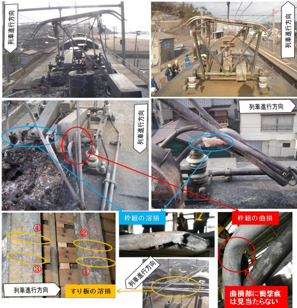
パンタグラフすり板の溶損状況
