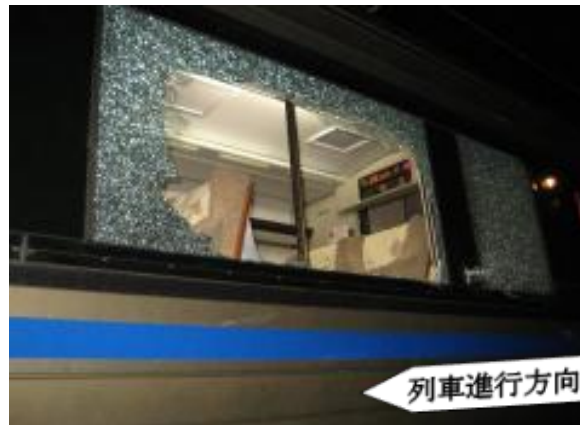
② 窓ガラスの破損
