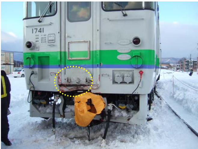
前面鋼体下部の凹みとホロ枠の破損
