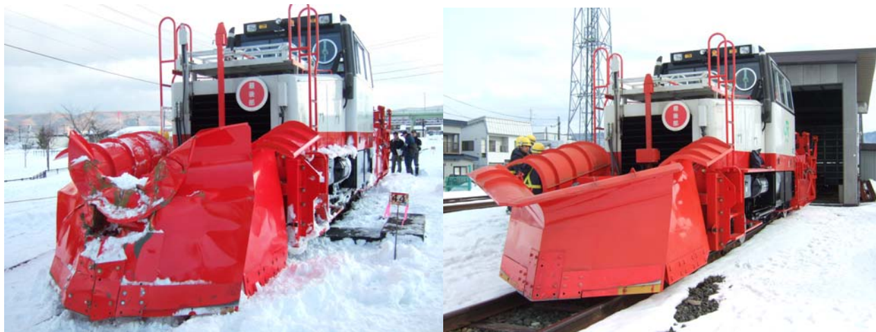
衝突後の状態
