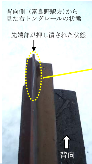
付図8 44号分岐器（トングレール等）の損傷状態
