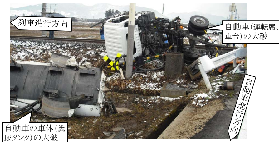
写真5 自動車の損傷状況
