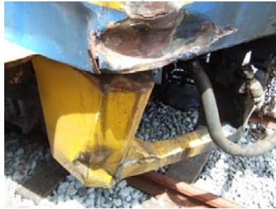
本件ダンプの荷台部分と衝突したと思われる痕跡と変形した前面右側スカート
