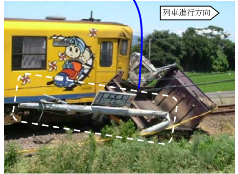
曲損したパンザマスト(建植位置から約8m移動)
