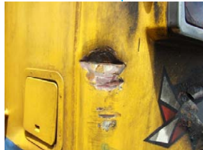
本件ダンプの荷台部分と衝突したと思われる痕跡
