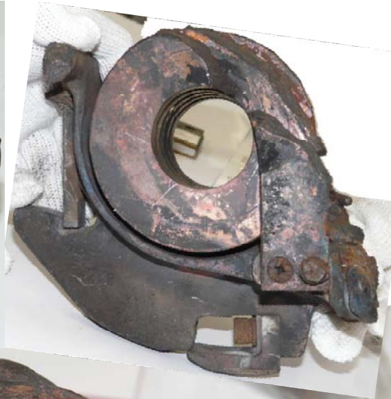
付図17 L1吹消しコイルの損傷状況
