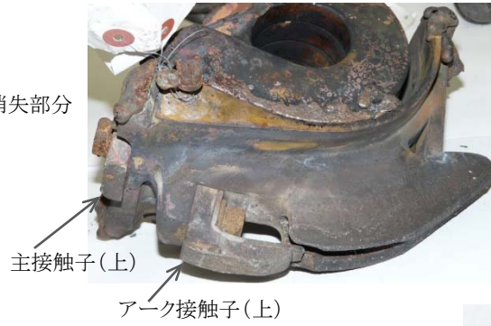
付図16 L1絶縁支柱とプラス端子取付金具等の損傷状況
