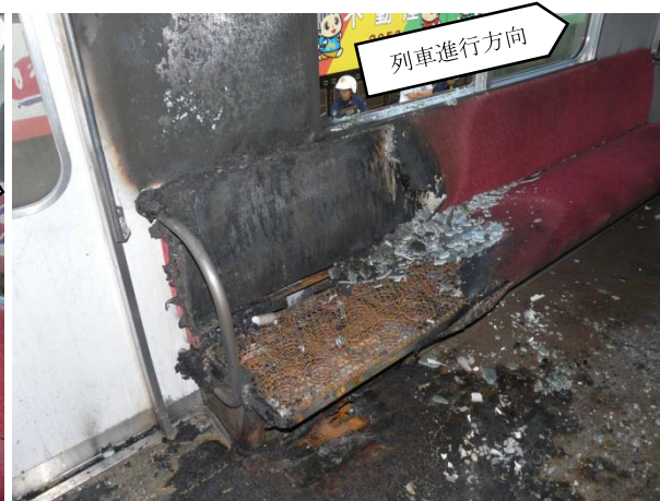
腰掛け付近の損傷状況
