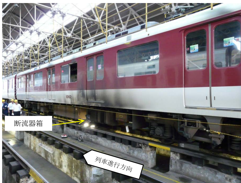
本件車両の損傷状況
