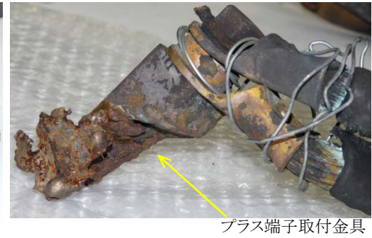
付図16 L1絶縁支柱とプラス端子取付金具等の損傷状況
