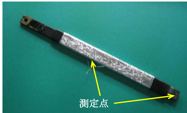
部分放電試験時の絶縁支柱の状態
