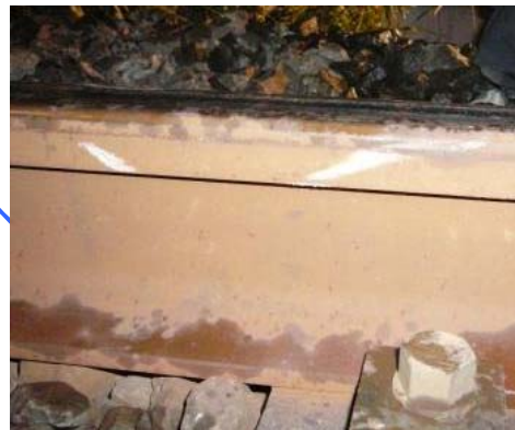
左レールのゲージコーナー部に見られた逆ハの字型の痕跡
