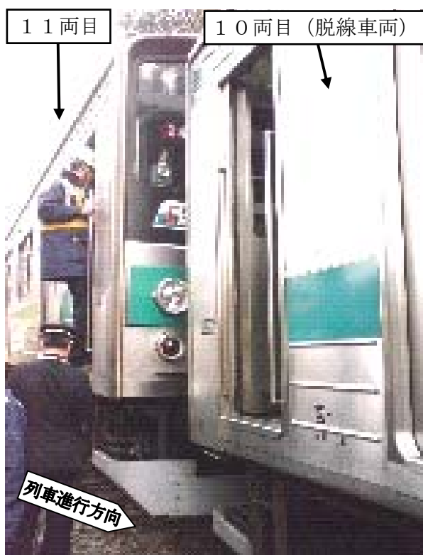
車体の変位状況
