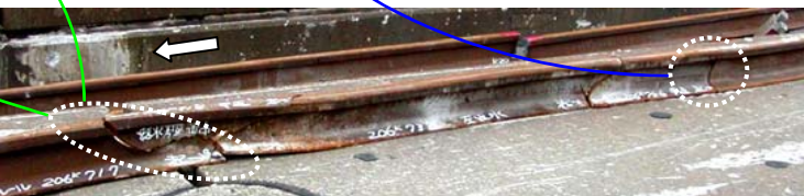
写真③のレール端部と、その間の破断したレールを組み合わせたもの(11月3日撮影)
