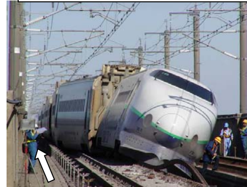
融雪排水溝に右車輪が落下して右へ傾いた10両目 (10月24日207k550m付近より撮影)
