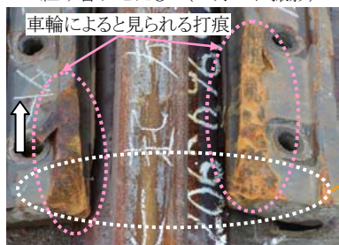
写真①の左レールと接着継目板を 組み合わせたもの(11月12日撮影)
