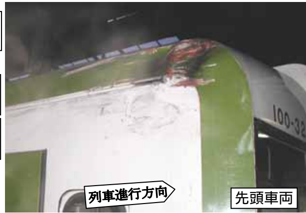
写真4 車体の損傷状況
