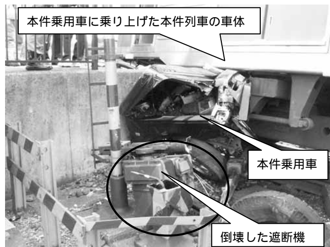
写真3 本件乗用車に乗り上げた本件列車の車体と倒壊した遮断機
