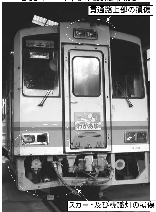
写真5 車両の損傷状況
