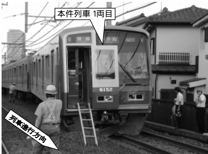
写真3 脱線現場の状況(1)
