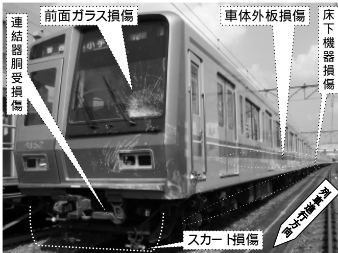
写真5 車両の損傷状況
