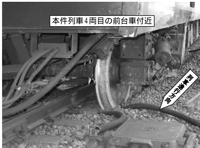
写真5 車両の損傷状況
