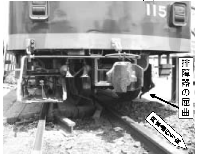
写真2 脱線現場の状況(2)
