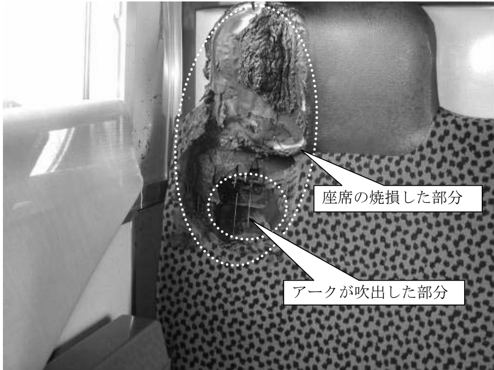
写真6 座席の焼損の状況 (本件列車の3両目車両の後部妻板に接した座席)
