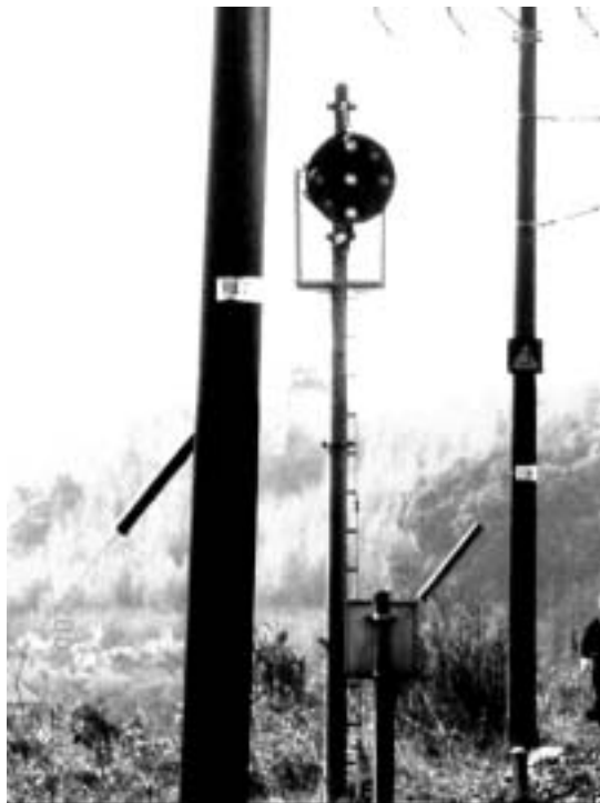
写真2 第3閉そく信号機の中継信号機 (進行中継信号を現示している状況)
