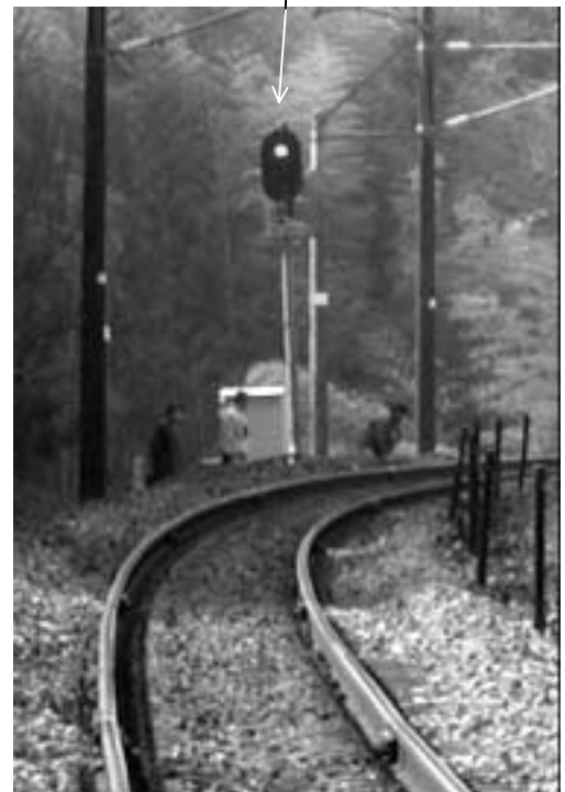
写真3 第3閉そく信号機 (進行信号を現示している状況)
