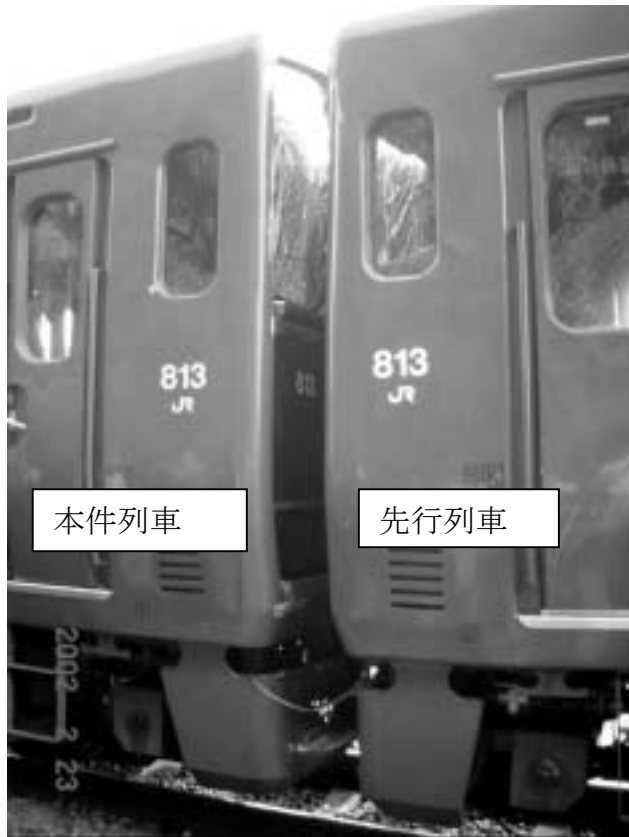
写真1 本件列車と先行列車の 衝突部付近の状況
