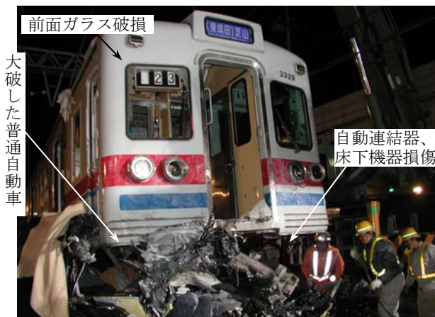
写真5 脱線現場の状況 (1両目前面)
