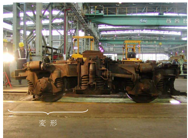
写真6 1両目前台車の損傷 状況
