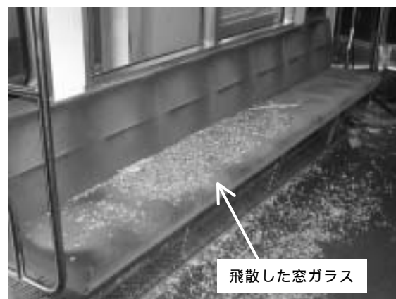
写真6 車両の損傷状況 (3両目車内、窓ガラスの破損)
