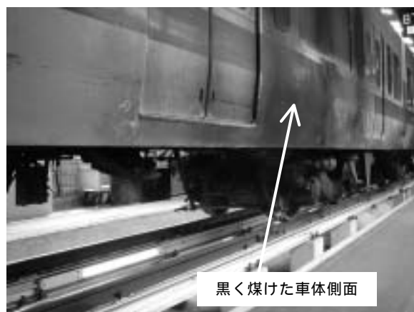
写真4 車両の損傷状況 (2両目左側面の焼損状況)
