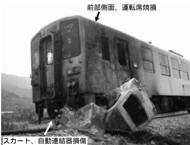
写真5 車両の損傷状況(1)
