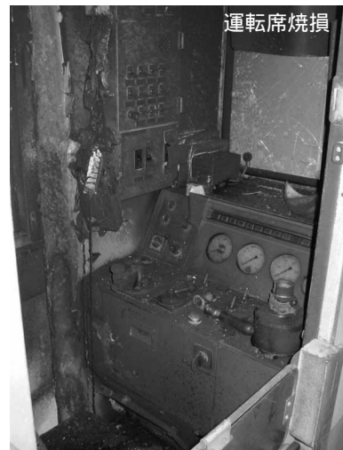
写真6 車両の損傷状況(2)
