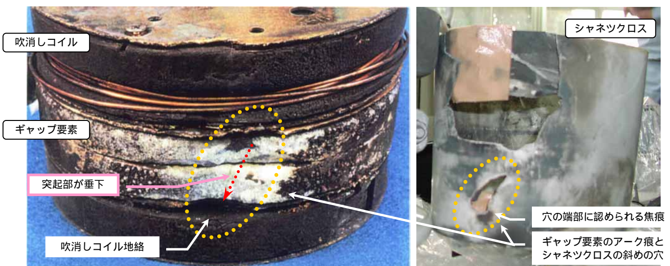
図 13 ギャップ要素及びシャネツクロスの状況
