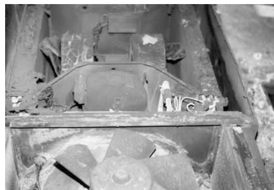
図20 クーラー本体の焼損
