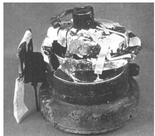
図 1 碍子破損状況（上下反転）
