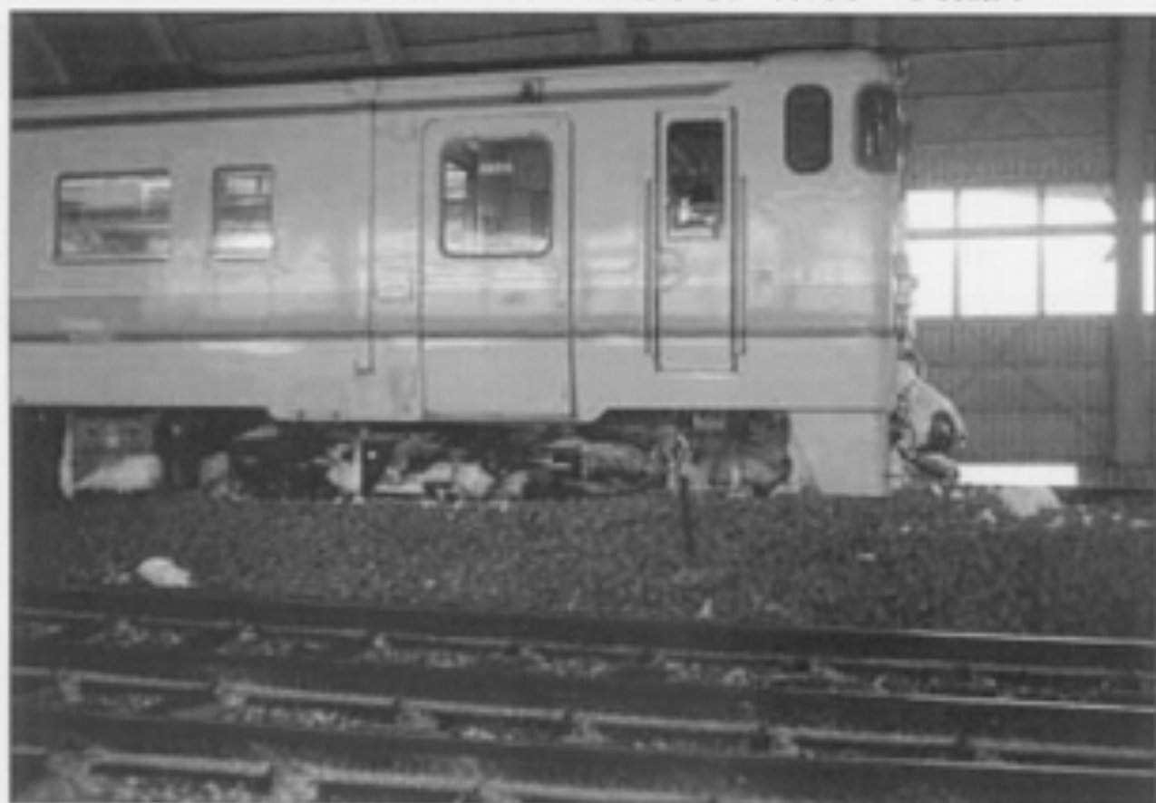
写真2 事故現場における脱線状況（右側から撮影）
