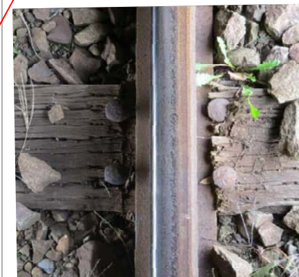
まくらぎ No.-13の状況 (事故車両を撤去する前の右レール)
