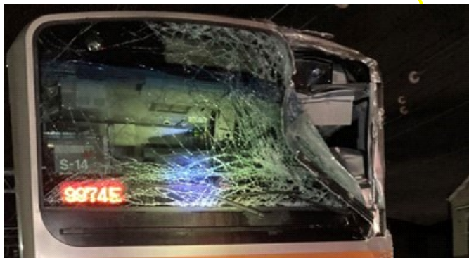
本事故発生直後の前面ガラスの破損状況
