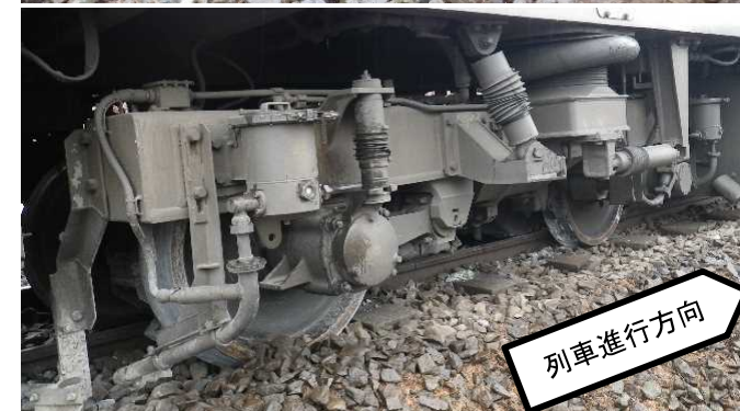
第5軸及び第6軸の脱線状況
