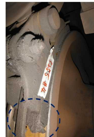
堆積した制輪子付着物の例 7両目(5255号車)
