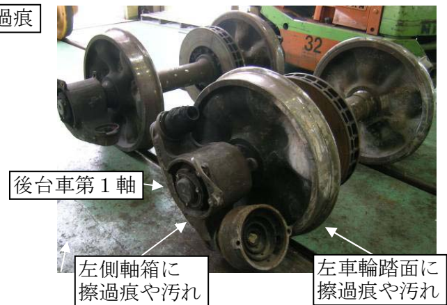
1両目後台車輪軸の損傷状況
