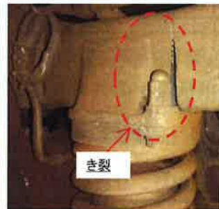
台車枠の一部にき裂
