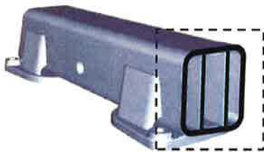
台車枠(側バリ)の切断モデル
