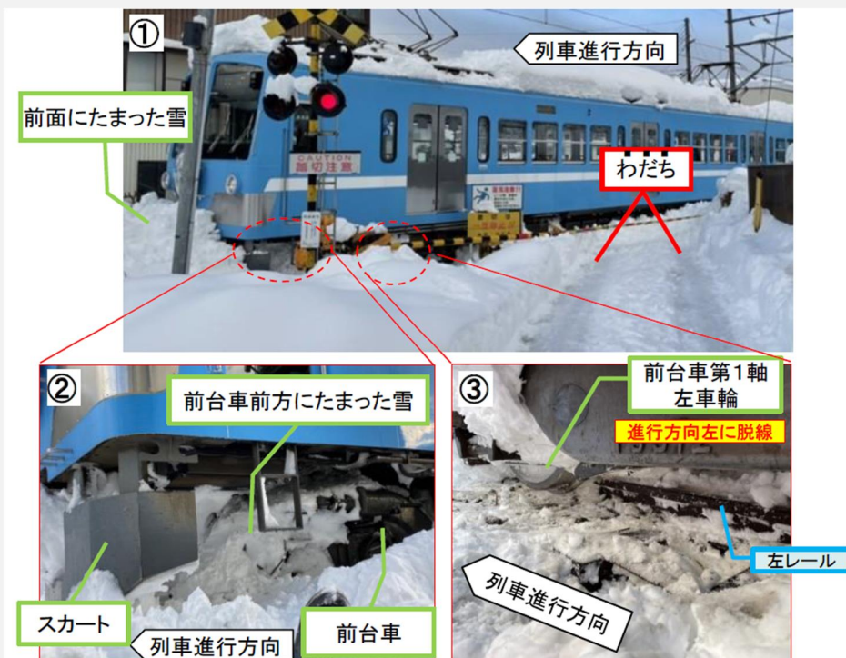
図18 本件事故現場の状況
