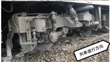
第5軸及び第6軸の脱線状況
