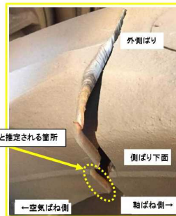
(脱線直後の本件亀裂(同社提供))
