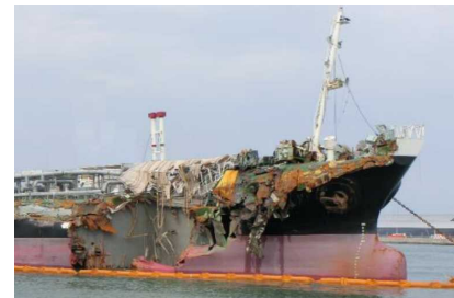
油タンカー宝運丸 橋梁衝突
