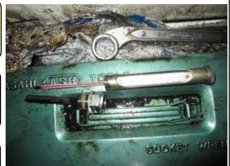
主機潤滑油冷却器下で発見された温度計、ケース枠及び感温外筒
