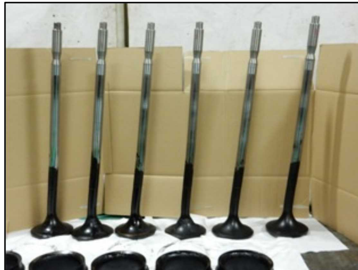
〈 曲損した吸気弁の弁棒 〉
