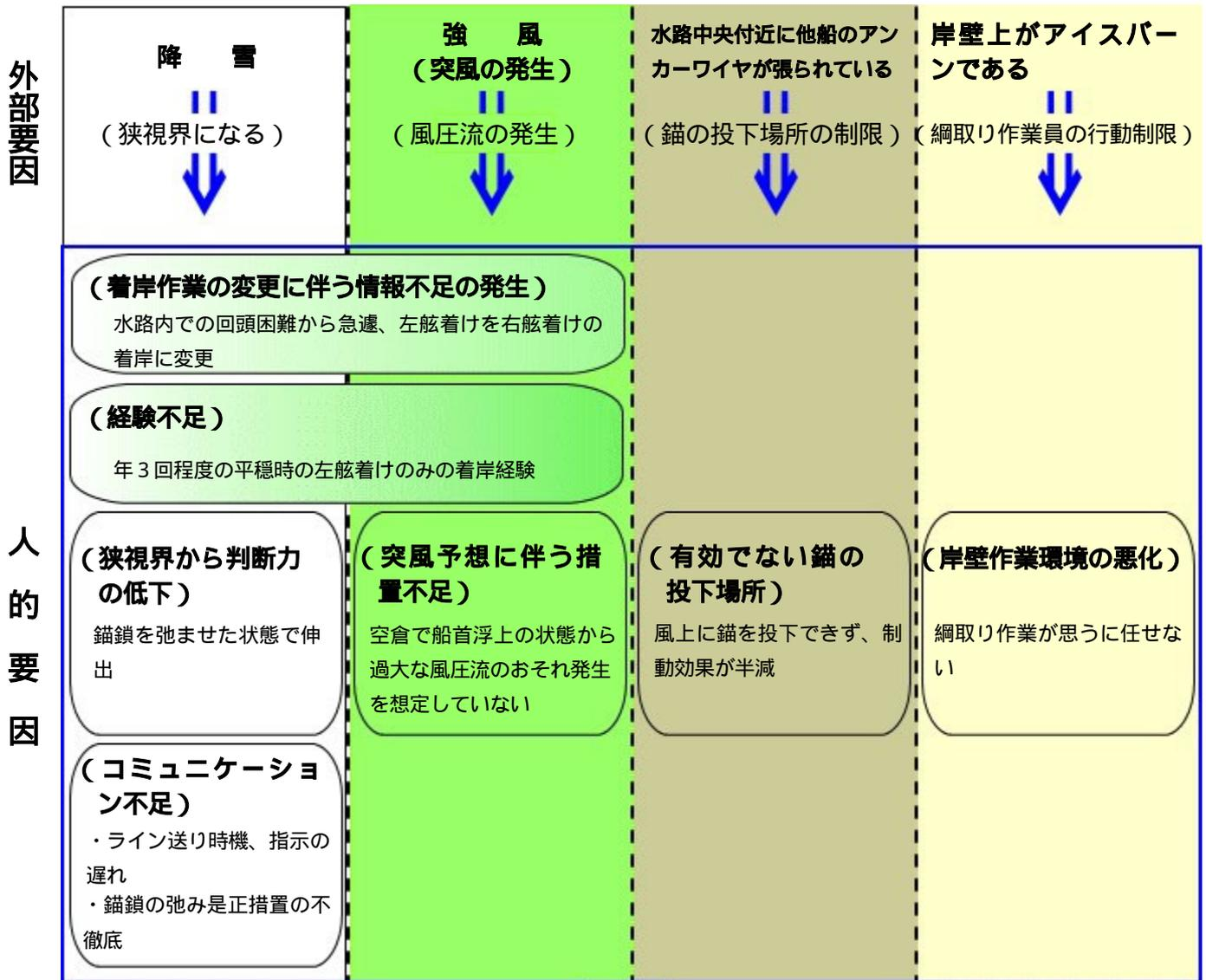
**海難発生** 突風による船首の圧流に対処できず岸壁衝突
