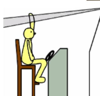
いすを使用する船では、センサーが頭頂部を検知しないように設置。いすに腰を掛けた状態では、一定間隔でブザーが鳴るので、その都度手を挙げてリセットする。
