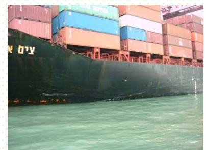
ジ号左舷船首部の擦過傷(白い部分)(香港)
