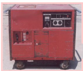
移動式発電機
