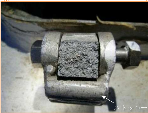
写真 2 1 船首甲板部ハッチ及びハッチ蓋のヒンジが折損
