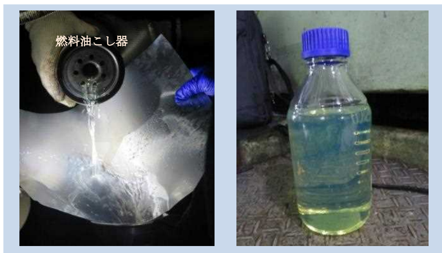
写真16 燃料油こし器から取り出した燃料油
