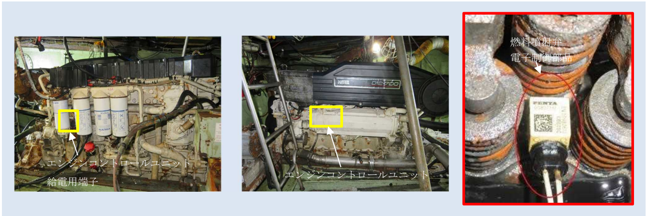
写真19 電子制御系部品の配置と燃料噴射装置
