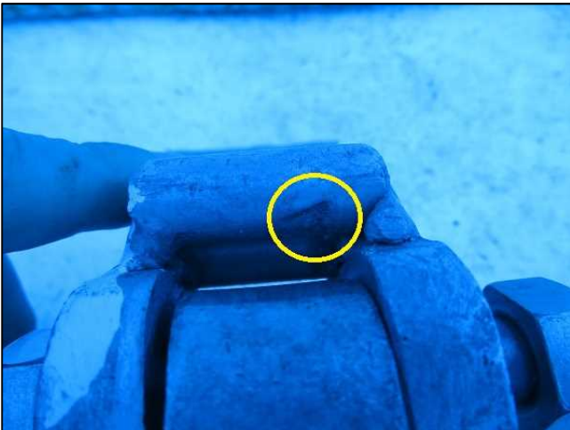
写真 2 2 左舷側ストッパーに衝突跡
