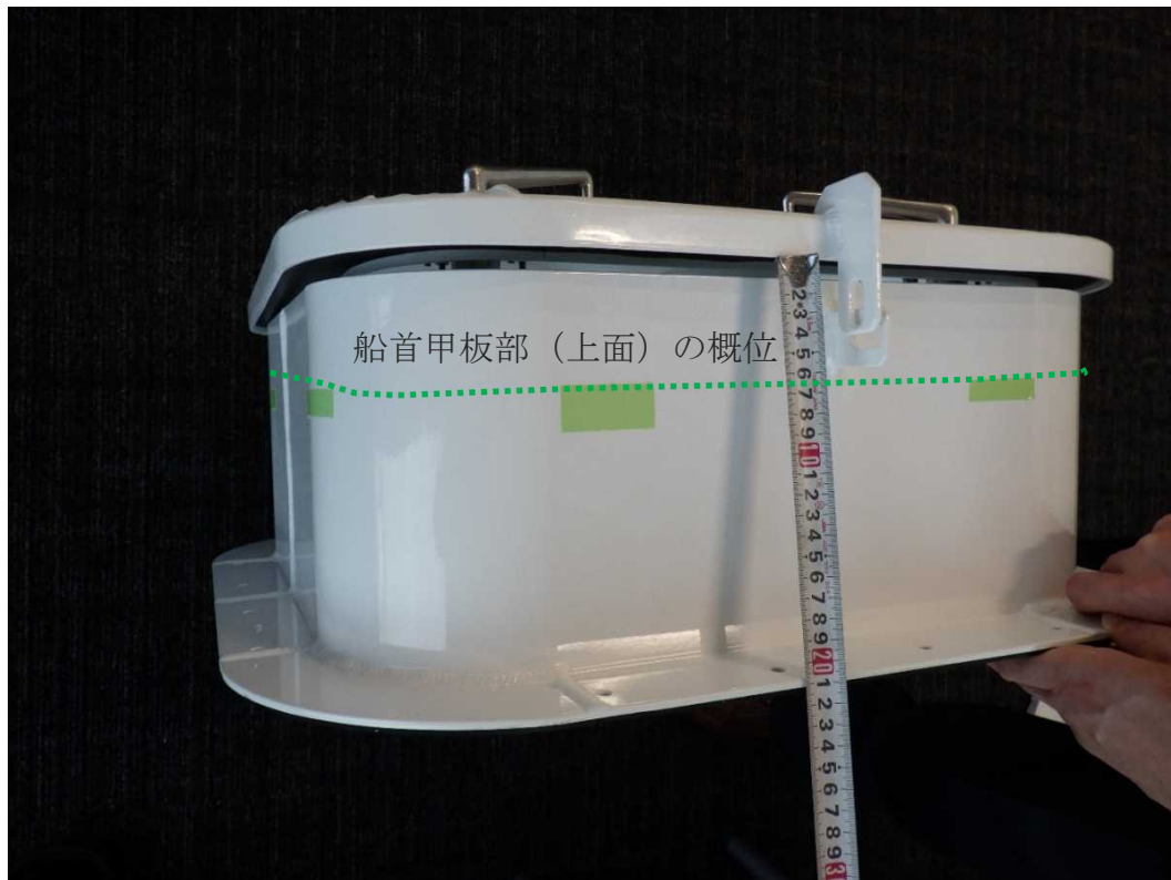
写真 3 1 ハッチ蓋とハッチコーミングとの間に隙間が生じた状態（模型ハッチで再現）
