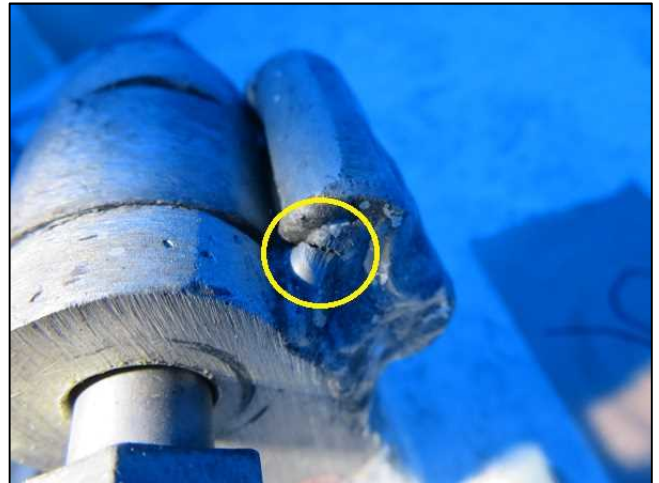
写真 2 3 右舷側ストッパーにクラック
