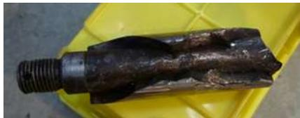
破断していたピン
