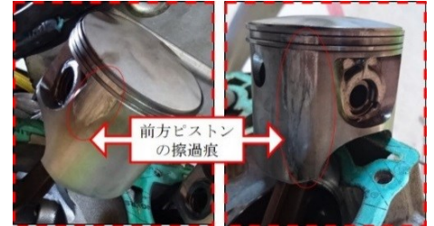
写真2 前方ピストンの擦過痕
