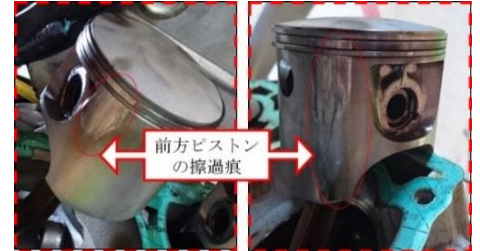
写真2 前方ピストンの擦過痕
