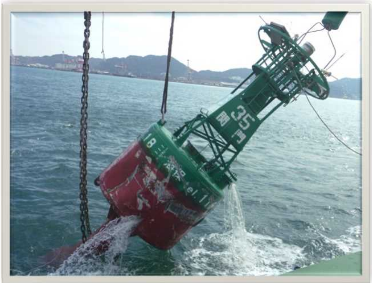
船舶事故により損傷を受けた関門航路第 35 号灯浮標
