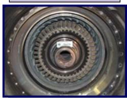
破断した PT ブレード
