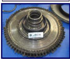
RGB ヘリカル・インプット・ギアシャフトが疲労破断したため、これらの部分にオーバーロードが発生して 2 次破壊が起こったことによるものと推定されます。(PW150A 型エンジン図のタービンセクション部分)
