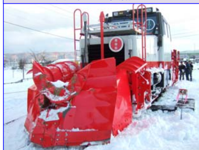
本件排モの損傷状態
