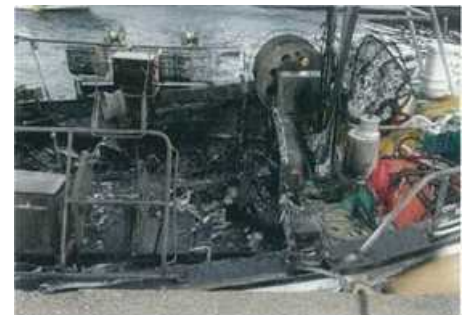
船首部の焼損状況
