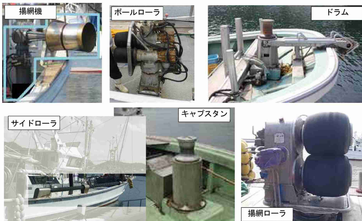
図3 揚網機等の例（事故調査報告書より）
