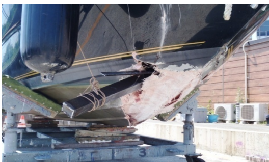
船底の損傷状況
