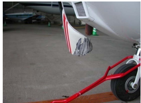
プロペラの損傷状況
