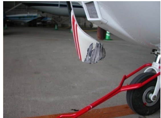
プロペラの損傷状況
