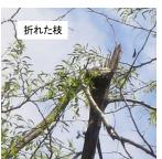
枝の折れた立木の周辺には更に樹高の高い木もあり、折れた枝の太さやその立木から接地痕まで の距離等から、同機は左旋回中に高度が大きく低下し、その際に左主翼が立木に衝突したものと考 えられる
