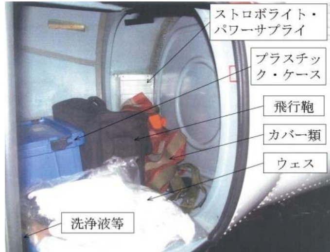
後方荷物室の積載物の状況（整備士の記憶により同型機で再現）
