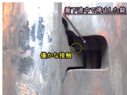
図6 錠が正規より高い位置で停止
