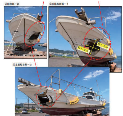
遊漁船第二愛丸の損傷状況
