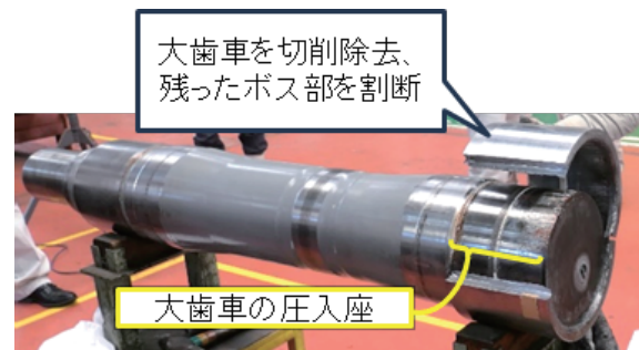
図2 車軸の折損状況
