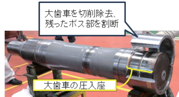
図2 車軸の折損状況
