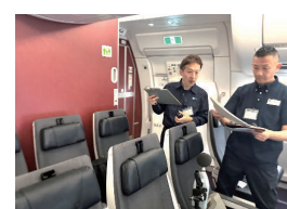
図3 拡声器の機内使用に係る検証実験作業風景
