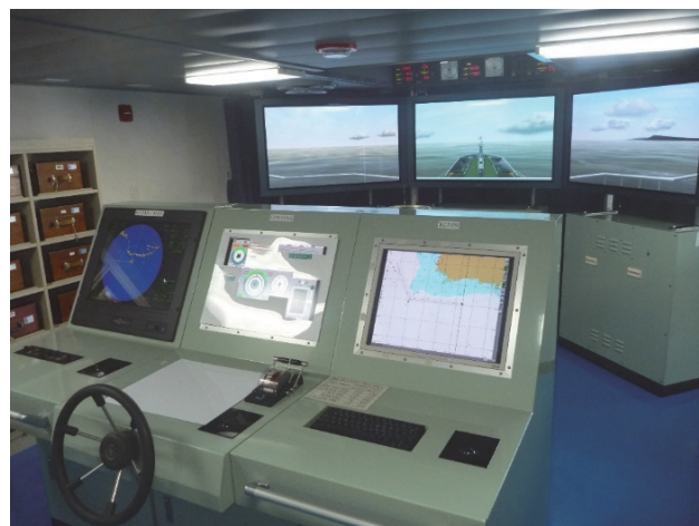
船橋階下の実習船橋に設置されている 操船シミュレーター
